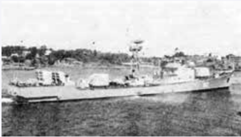
Mirka-lk:n sukellusvenehävittäjä, 1200 tn, nop 28 kn., aseistus 2 76 mm:n kaksoistornia, 5 sutotorp. keitintä, 4 kpl 12-putkista suto-rak.heitintä.
