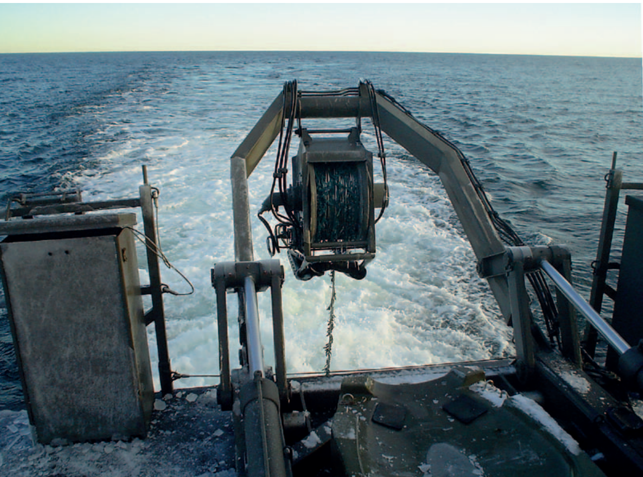
Sukellusveneen etsintää Rauma-luokan ohjusveneen syvyytettävällä kaikumittaimella.
