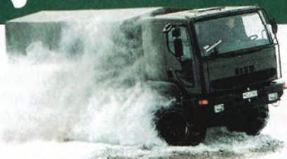
Puolustusvoimien tilaamissa Sisu HMTV 6x6:ssa on Cummins M11 380E dieselmoottori, jonka suurin teho on 278kW/380 hv. Vaihteistona 6-vaihteinen Allison-täysautomaattivaihteisto.
