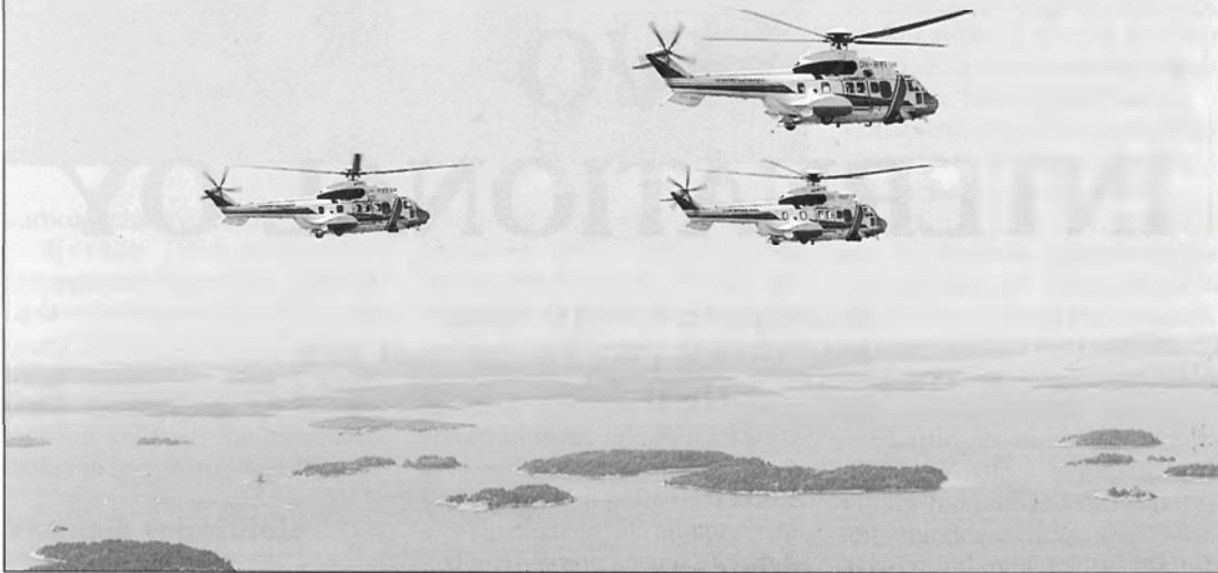
AS 332 Super Puma on ranskalainen kaksimoottorinen keskiraskas helikopteri, jota käytetään meripelastukseen, merirajan vartiointiin ja kuljetustehtäviin. Kopteri on varustettu jäänpoistolaitteilla.
