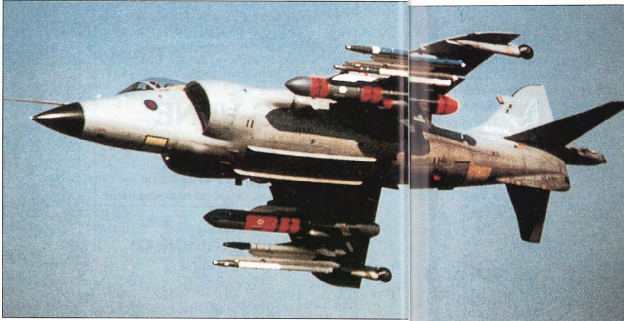
Britannian merivoimien Sea Harrierin asekuormassa Sea Eagle -ohjukset ovat lähinnä koneen runkoa.
