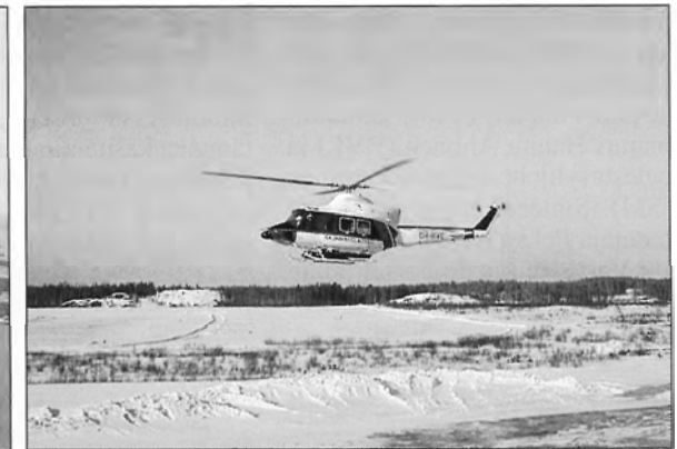
Myös Agusta Bell 412 Jet Ranger on valmistettu Italiassa amerikkalaisella lisenssillä. 412 on kaksimoottorinen, mutta ei ole mittarilentokelpoinen. Koneita käytetään rajavartiointiin maalla ja merellä sekä myös meripelastustehtäviin.
