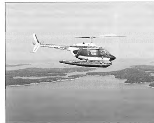
Agusta Bell 206 Jet Ranger on Italiassa lisenssillä valmistettu amerikkalainen kevyt yksimoottorinen helikopteri. Tyyppi ei ole mittarilentokelpoinen
